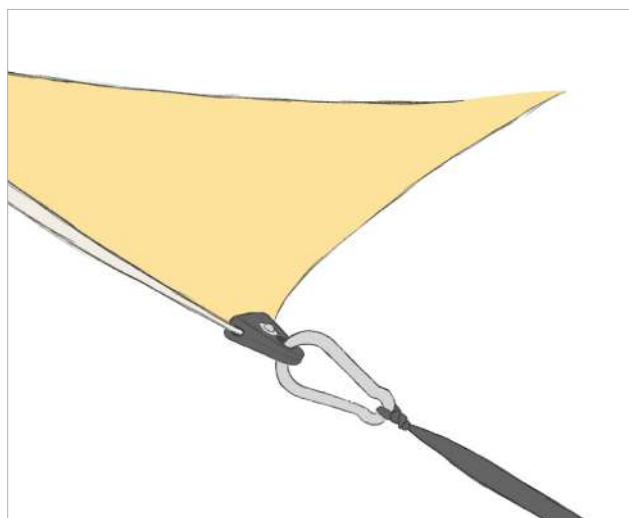
Mousqueton sur la pince de fixation latérale sans mât
