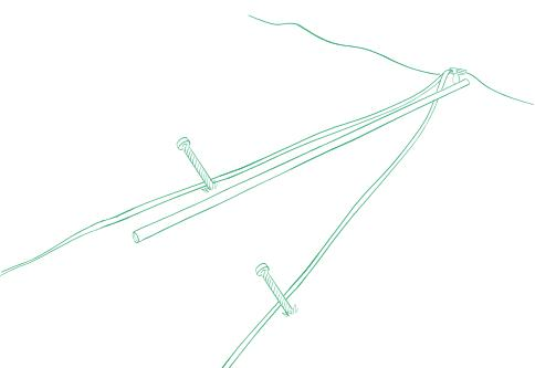
Montieren Sie die Heringe etwa 2 m von der Zeltplane entfernt.
