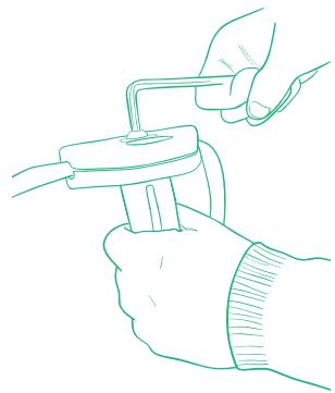
Wenn alles korrekt montiert worden ist, passt es perfekt in das vorgebohrte 16-mm-Loch (sehen Sie Schritt 5).
