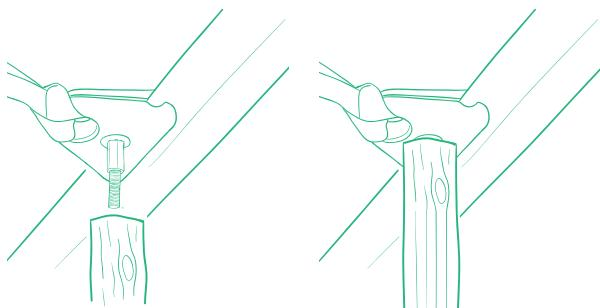
Wenn alle Pfähle befestigt sind, drücken Sie sie einen nach dem andern nach oben unter das Stretchtuch und versehen Sie jeden Aluminiumpfahl mit einem Pfahlfuß. Sie können die Spannriemen jeweils ein wenig straffen, aber noch nicht vollständig spannen.
