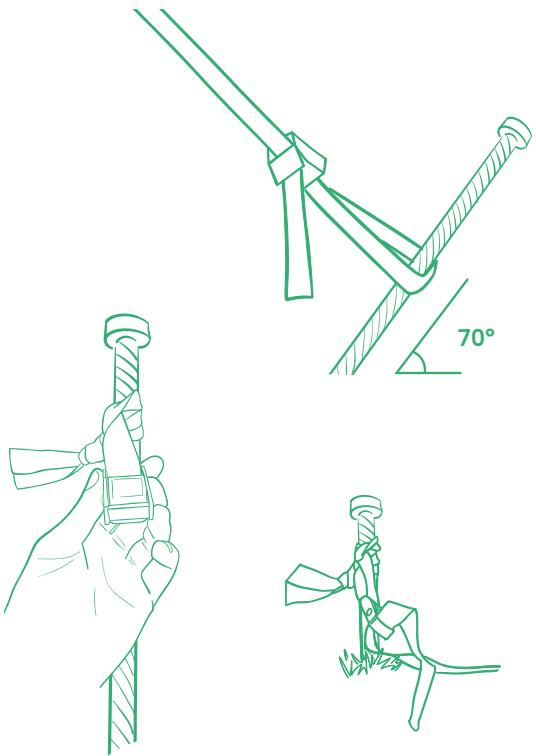
Um den Hering gut zu befestigen, setzen Sie den Hering in einem Winkel von 70° an und schlagen Sie den Hering in Richtung des Zelts in den Boden. An den Ecken, an denen keine Pfähle aufgestellt werden, dürfen die Heringe in einem Abstand von etwa 1,5 m bis 2 m vom Stretchtuch angebracht werden.
