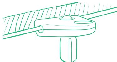
Maak een lange paal door 2 buizen van 110 cm en 1 buis van 50 cm te koppelen met behulp van 2 koppelingen. Herhaal dit nog 3 keer en leg telkens zo'n samengestelde paal bij een zijklem.
