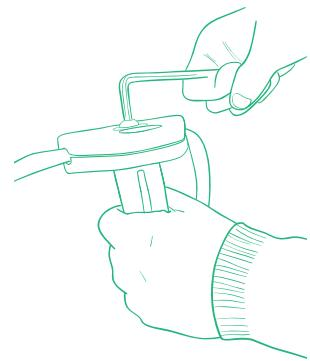
Lorsque tout est assemblé correctement, l'écrou s'insère parfaitement dans le trou prépercé de 16 mm (voyez étape 5).
