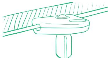
Conecta 2 tubos de 110 cm y 1 de 50 cm con dos conectores para crear un poste largo. Repite este paso tres veces y lleva cada poste montado al lado de la abrazadera lateral.
