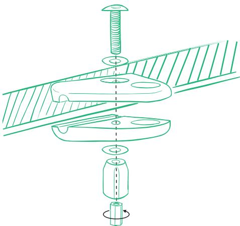
Voor de montage van elke zijklem heb je volgende onderdelen nodig: 2 driehoeken, 1 bout, 2 sluitringen, 1 lange moer en 1 handgreep. Plaats een zijklem in het midden van elke zijde van het stretchdoek.
