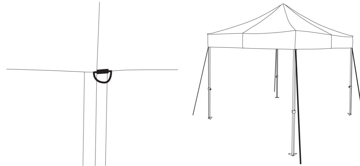
Vous pouvez fixer les parois latérales au sol à l'aide de sardines à enficher dans les boucles prévues à cet effet. Les platines qui équipent les poteaux de la tonnelle sont également pourvues d'orifices servant à cet effet. Il vous suffit ensuite de poser les lestes sur les platines.
