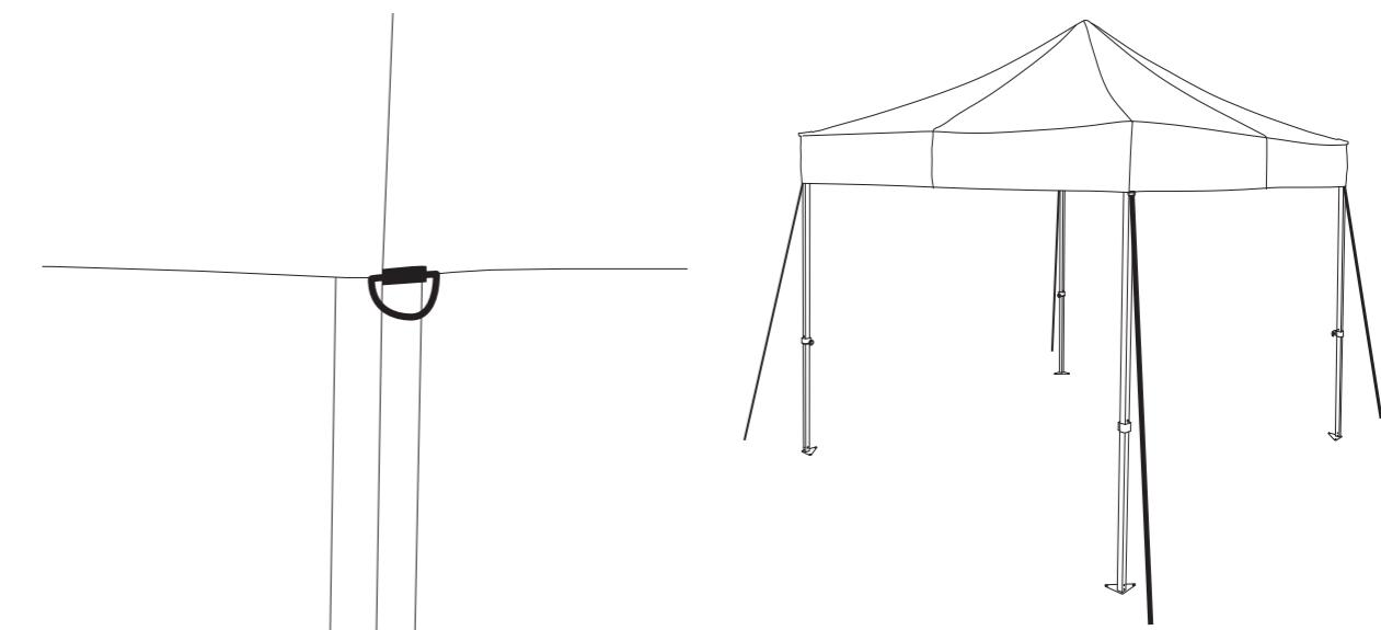
Se pueden fijar los bordes inferiores de las paredes laterales con piquetas en los bucles previstos para ello. También hay agujeros en las placas base de las patas para este propósito. También se pueden colocar contrapesos en las placas base.
